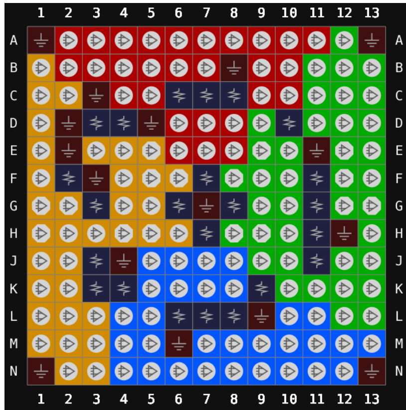
图 3-55 GW1N-4 器件 UG169 封装管脚分布示意图（顶视图）
